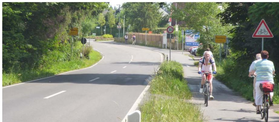
*Abbildung 7-26: Querungshilfe am Ortseingang Urdenbacher Weg in Baumberg zur Sicherung des querenden Radverkehrs und zur Sichtbarmachung der Fahrbahnführung ab Ortseingang*
