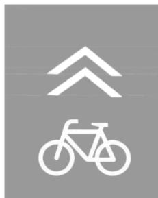
Abbildung 6-4: Piktogramm „sharrow“ zur Verdeutlichung des Mischverkehrs auf der Fahrbahn
