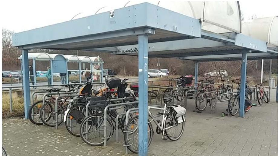
*Abbildung 11-3: Anlehnbügel mit Fixiermöglichkeit*
